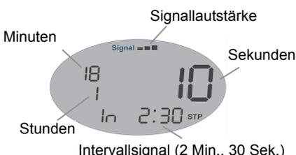
In der Betriebsart **STP** wird die laufende Zeit angezeigt. Nach Ablauf der eingestellten Intervallzeit wird jeweils ein Signalton ausgegeben. Die Zeitmessung läuft weiter, bis der Benutzer das Programm manuell beendet.
